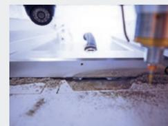
Quando si tratta di precisione e velocità, la pulizia è un fattore decisivo. Il sistema di pulizia interna Pi-Clean, completamente automatico, garantisce una pulizia rapida e completa dell'area di lavoro. Inoltre, il sistema di aspirazione completamente automatico rimuove in modo sicuro trucioli e polvere. Un pre-separatore di trucioli con turbina a ciclone completa il sistema.
