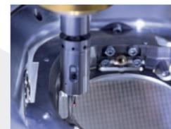
Sistema di misurazione tattile 3D ad alta precisione per calibrare la fresatrice e misurare i pezzi ibridi sinterizzati al laser. Eventuali deviazioni di forma vengono rettifiche fino a ottenere un adattamento perfetto. Fornito come parte integrante della macchina, rappresenta un'innovazione nel settore dentale.
